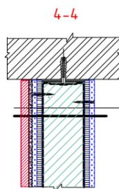
Перегородка ГКЛ на 100/125 мм
